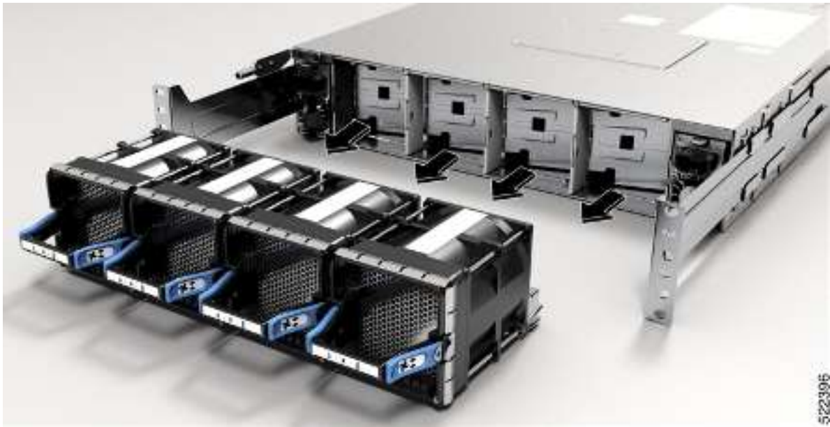
Figure 70: Remove Cisco 8202-32FH -M Fan Modules
